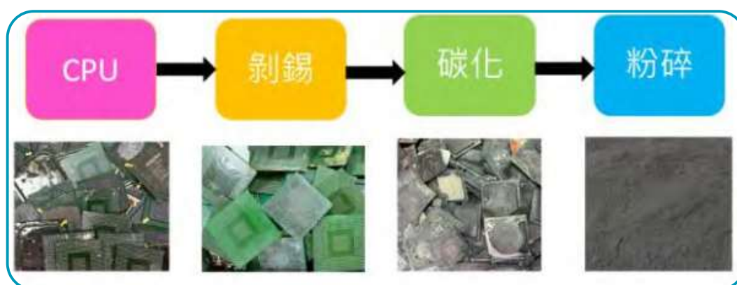
圖 5 CPU 剥錫、碳化、粉碎的過程
